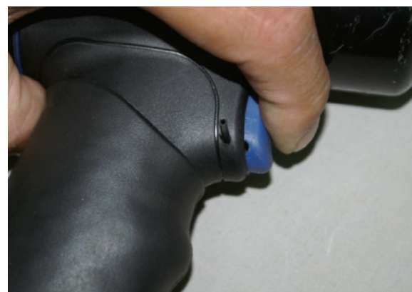
⑤エアーツールオイルをふきかけトリガーを元に戻し、グリップの戻りを確認します。
